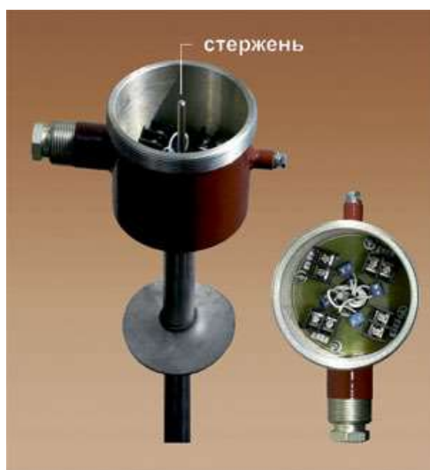
Рис.5. ПМП-152. Внешний вид. На стержне крепятся платы герконов, которые можно передвигать для настройки уровней.
