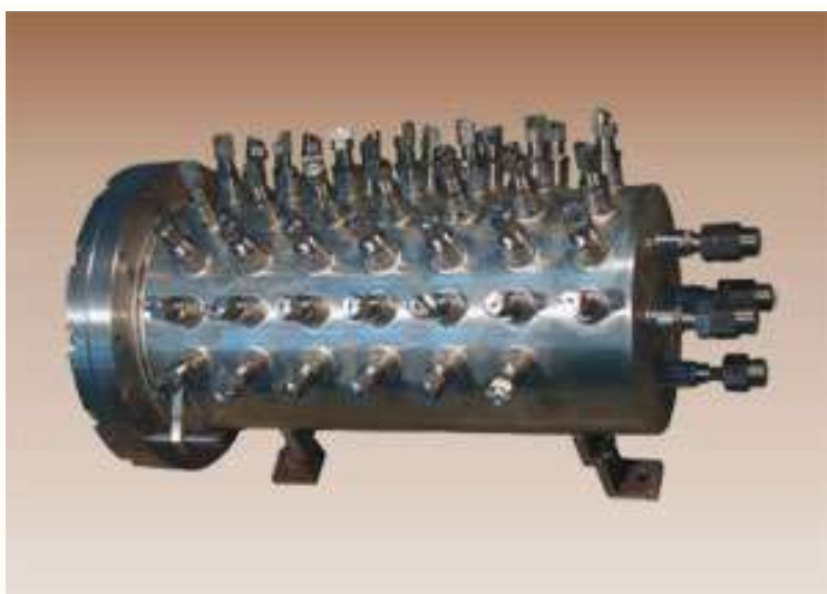
Рис.2. Корпус из стали 12Х18Н10Т, (600х338х309) мм, имеющей 44 кабельных ввода - для размещения приборов телеметрии. Эксплуатируется на космодроме.
