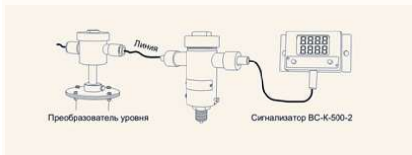
Рис.4. В линии могут функционировать датчики различных типов, что позволяет объединять различные системы контроля в одну: контроль давления + контроль переполнения, герметичности резервуаров + контроль загазованности и т.д.
