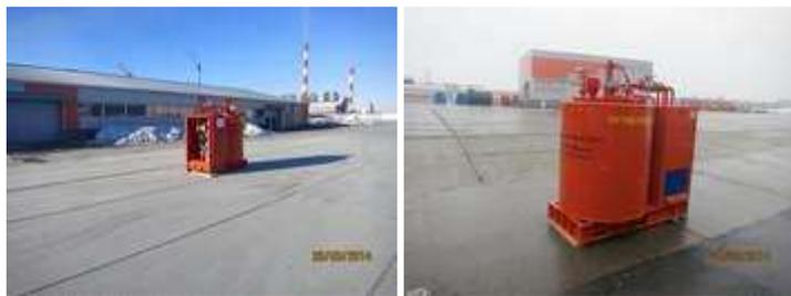
В случае нарушения непроницаемости стенок емкости видно падение уровня антифриза, и на землю или на воду попадет не топливо, а антифриз. Каждая емкость проверяется на непроницаемость под давлением 3 бара (300 кПа).
